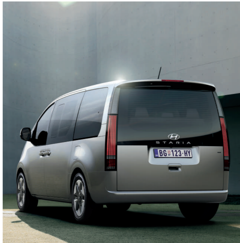
Parametarska piksel svetla (LED kombinovana zadnja svetla)
