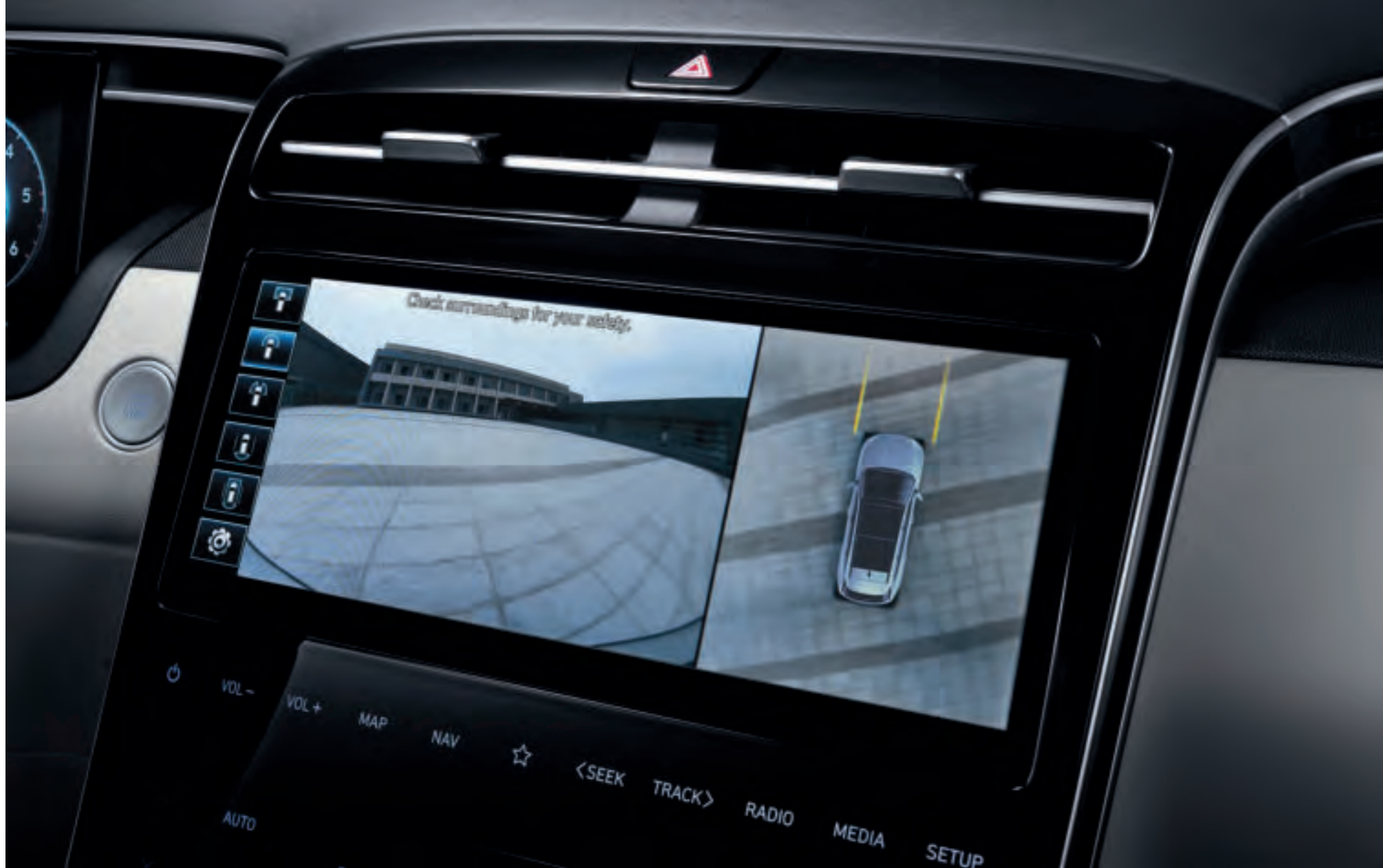
Kamera 360° za prikaz prostora oko vozila. Uživate u vidljivosti od 360° za lakše i bezbednije parkiranje. Četiri kamere visoke definicije montirane napred, bočno i na zadnjoj strani vozila prikazuju okruženje u realnom vremenu.
